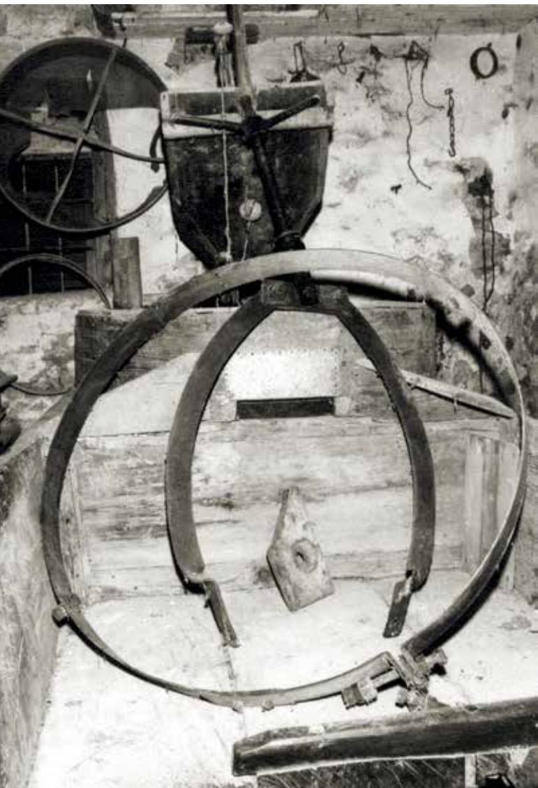
Štranjev malen – železni obroč za dvigovanje mlinskih kamnov (fotografija: Rino Tagliapietra).
