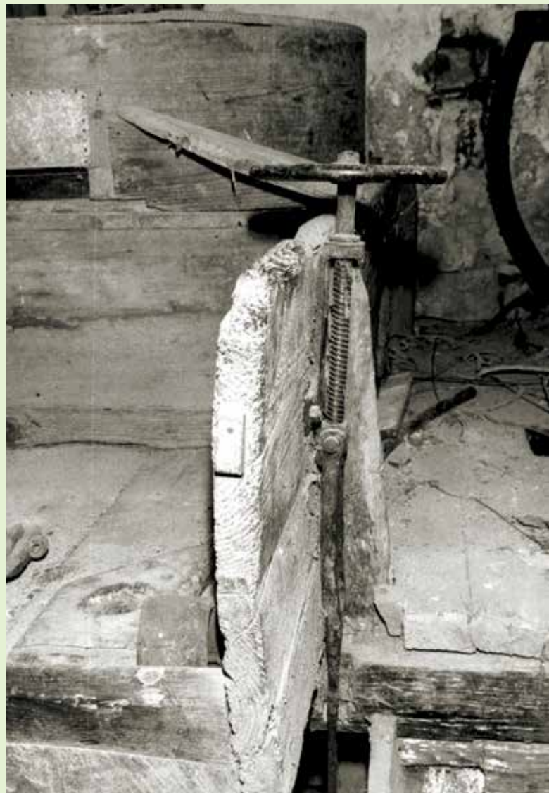
Štranjev malen – vijačno vreteno za dviganje/spušcanje vrhnjaka (fotografija: Rino Tagliapietra).
