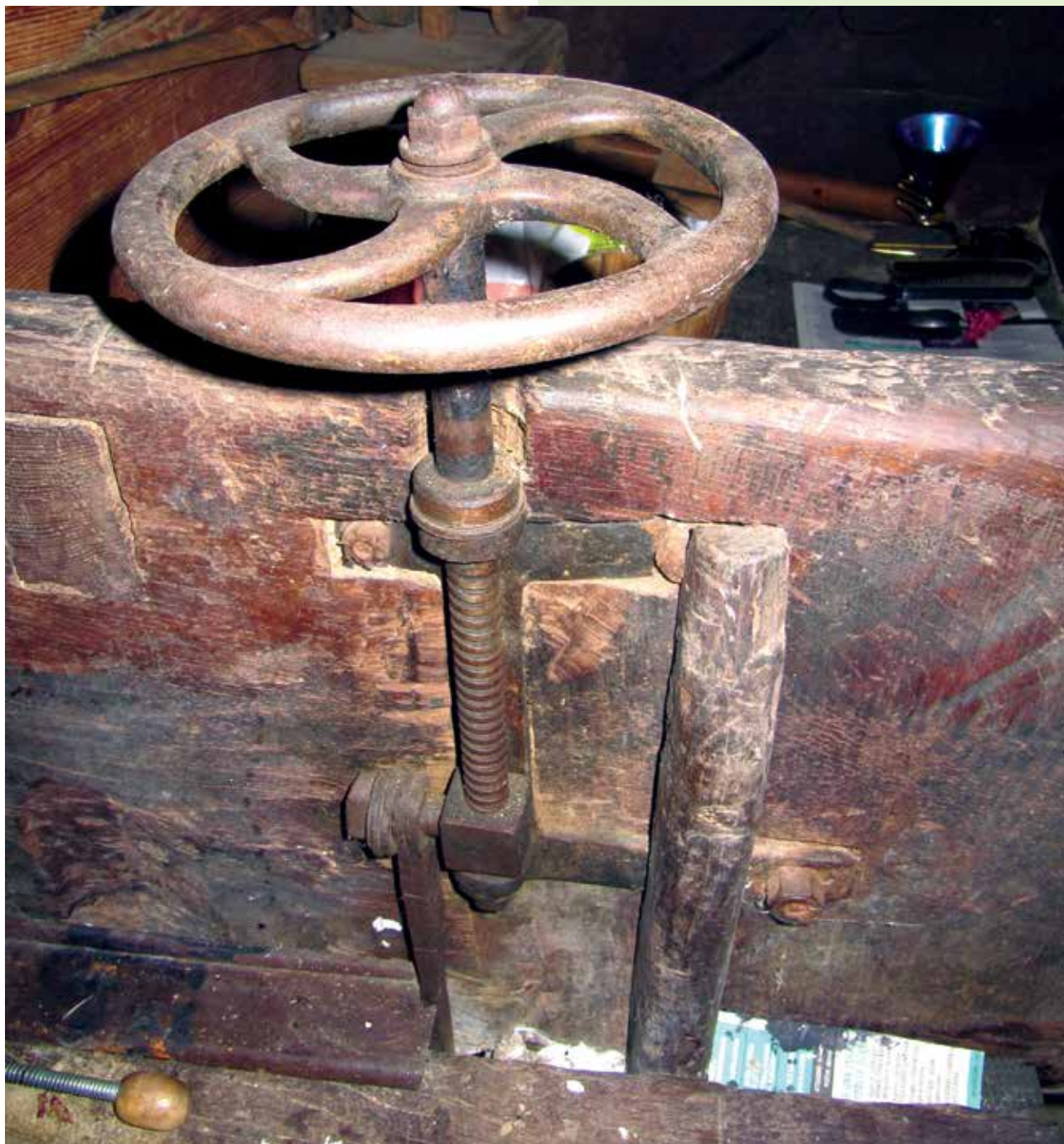
Notranjost Štranjevega malna. Detajl vijačnega vretena za odmikanje in primikanje vrhnjaka.
