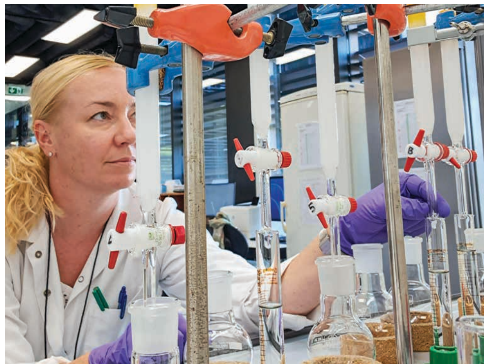
Kolonska kromatografija pri analizi stigmastadienov za ugotavljanje potvorb oljčnega olja. Column chromatography in the analysis of stigmastadienes for detecting olive oil adulteration.
