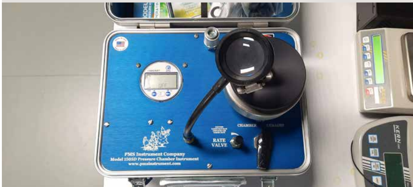
Scholandrova tlačna komora, model 1505D, za meritve listnega vodnega potenciala
