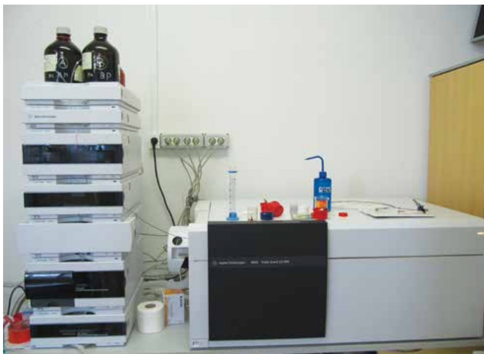
Tekočinski kromatograf Agilent Technologies 1260 z masnim detektorjem Agilent Technologies 6420 QQQ LC/MS system za določitev sestave in vsebnosti biofenolov.
