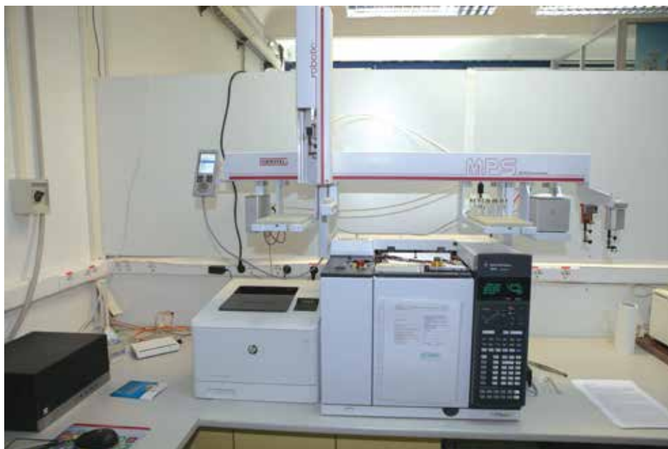
Plinski kromatograf Agilent Technologies 7890B z masnim detektorjem Agilent Technologies 5975C inert MSD Triple-Axis in vzorčevalnikom Gerstel Robotics za določitev vsebnosti hlapnih spojin.
