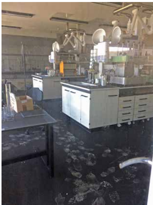
Posledice požara v Laboratoriju v oktobru 2017, Kampus Livade Izola
